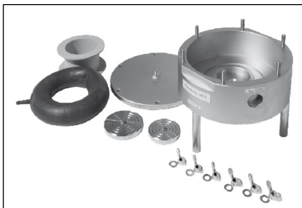
Ukompletowanie komory badawczej.
